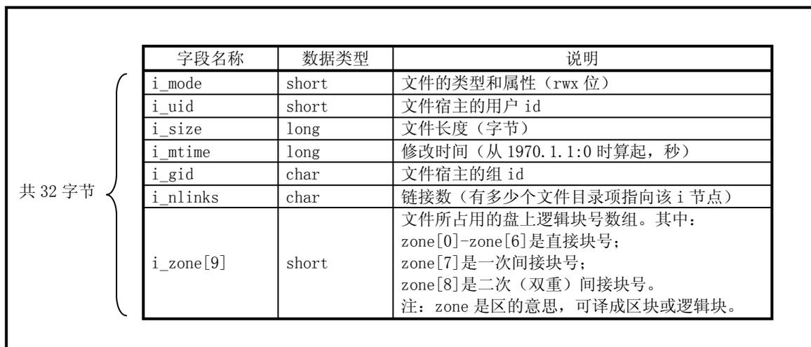
图9.3 MINIX 文件系统 1.0 版的 *i* 节点结构
